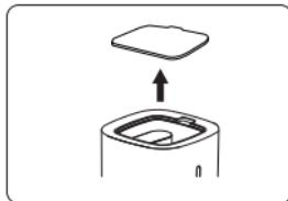
③本体水槽に水タンクをセットして、水タンクカバーを取り外してください。
